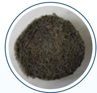
Querschnitt FIBALON<sup>®</sup> Kugel (beladen)
